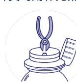
第二步： 切掉瓶塞中间部，留出 可供注射器插入的开口
